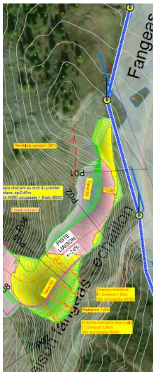
Figure 36 : réseau de neige de culture joutant la zone de terrassement (source : AD2i)
